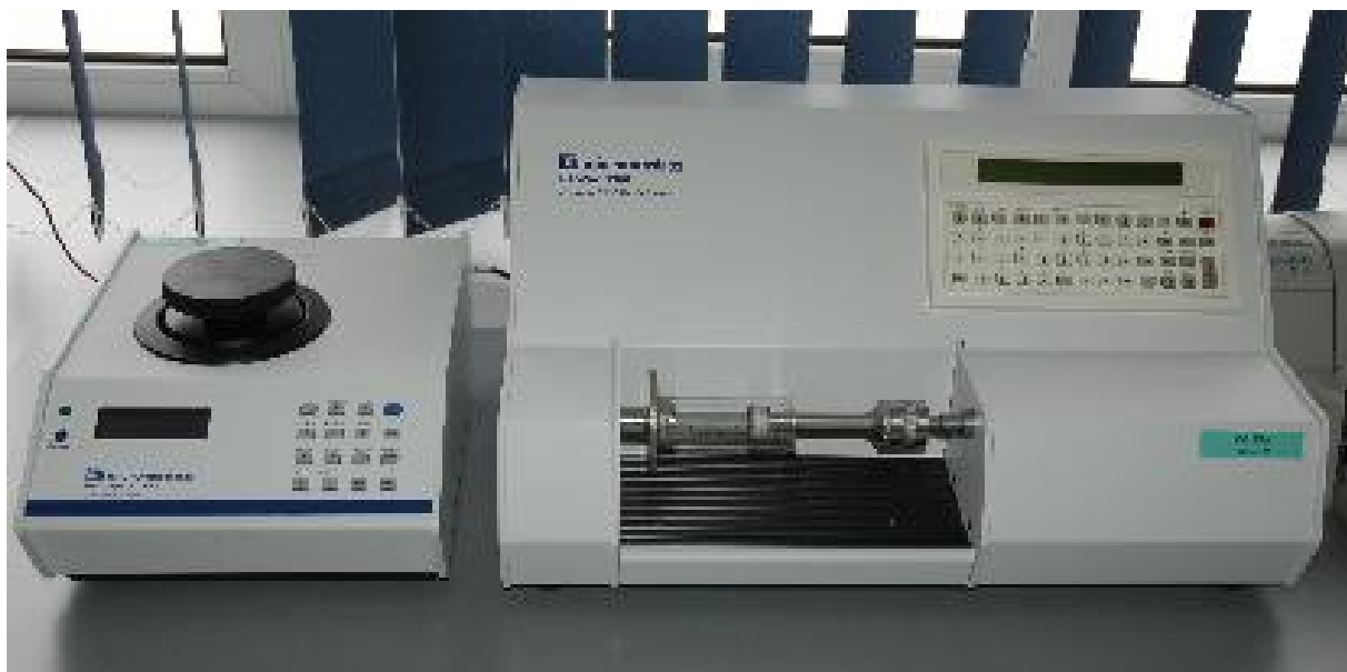
Rys. 1. Piknometry: helowy (AccuPyc II 1340) – z lewej i quasi-cieczowy (GeoPyc 1360) – z prawej.
